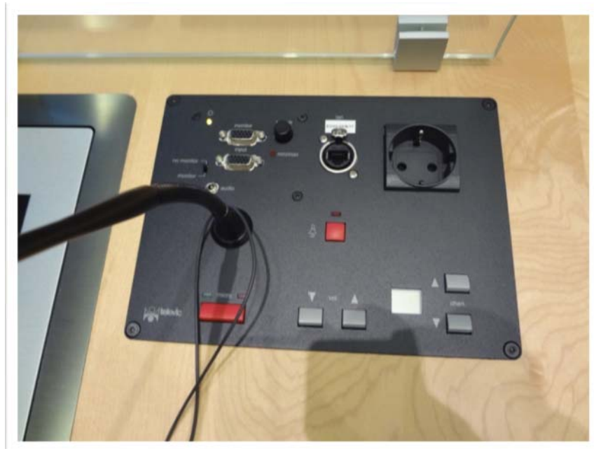
Abbildung 1: Haupttisch - Platine "Delegierter"
